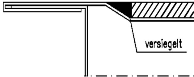
Die Montage des Sockels, sowie der Bodendichtung selbst, hat wie in den zugehörigen Montageanleitungen der Fa. Planet bzw. Fa. Athmer beschrieben, auf der Bandgegenseite der Tür, zu erfolgen. Die Bodendichtung kann mittels doppelseitigem Klebeband oder Silikon, vor dem verschrauben, provisorisch fixiert werden.
