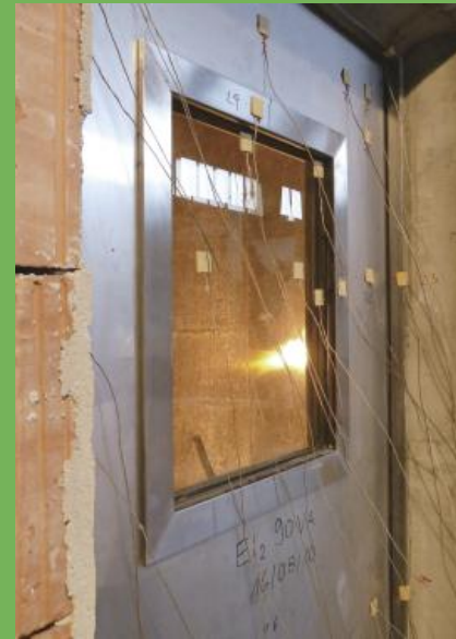
SystemSchröders TSN-11 T90 (EI 2 90) mit Verglasung im Brandversuch
